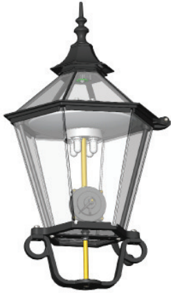
Vor der Rekonstruktion wurde die Leuchte mit modernster CAD-Software komplett erfasst
